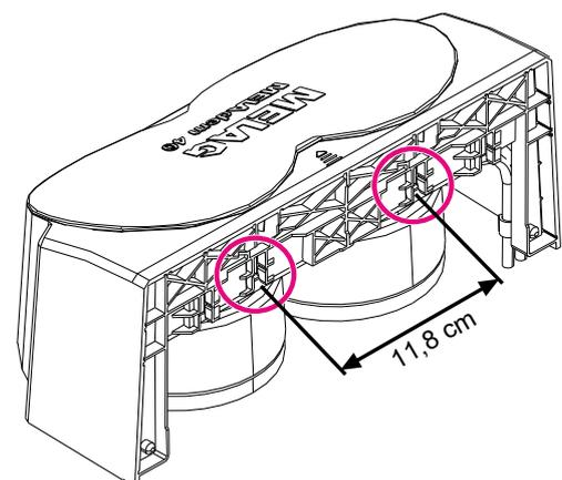
2. Bohren Sie unter Beachtung der Höhe der Anlage die Befestigungsbohrungen (Abstand: 11,8 cm) an der Wand.
