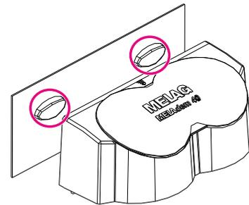
2. Hängen Sie die Anlage senkrecht von oben in die Halterungen ein. Schieben Sie die Anlage nach unten, bis das Gehäuse in den Halterungen einrastet.
