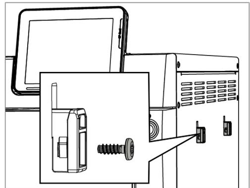
4. Hängen Sie die Anlage senkrecht von oben in die Halterungen ein. Schieben Sie die Anlage nach unten, bis das Gehäuse in den Halterungen einrastet.
