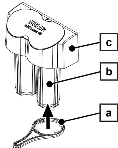
2. Drehen Sie den Behälterschlüssel nach links, um den Patronenbehälter zu öffnen.
